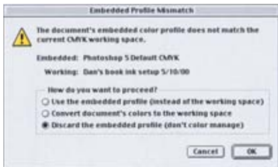
Рис. 11.10. Диалоговое окно, которое появляется на экране при открытии поступившего файла. Первое, что предлагает Photoshop 6 - оставить тэг. В RGB это почти всегда правильно. В CMYK это иногда правильно, но во многих, или даже в большинстве случаев тэг следует отбросить.
