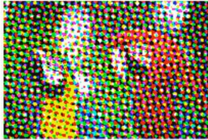
Рис. 1б. Пример растривания с использованием линиатуры 100 lpi
