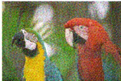
Рис. 1г. Пример растривания с использованием линиатуры 200 lpi
