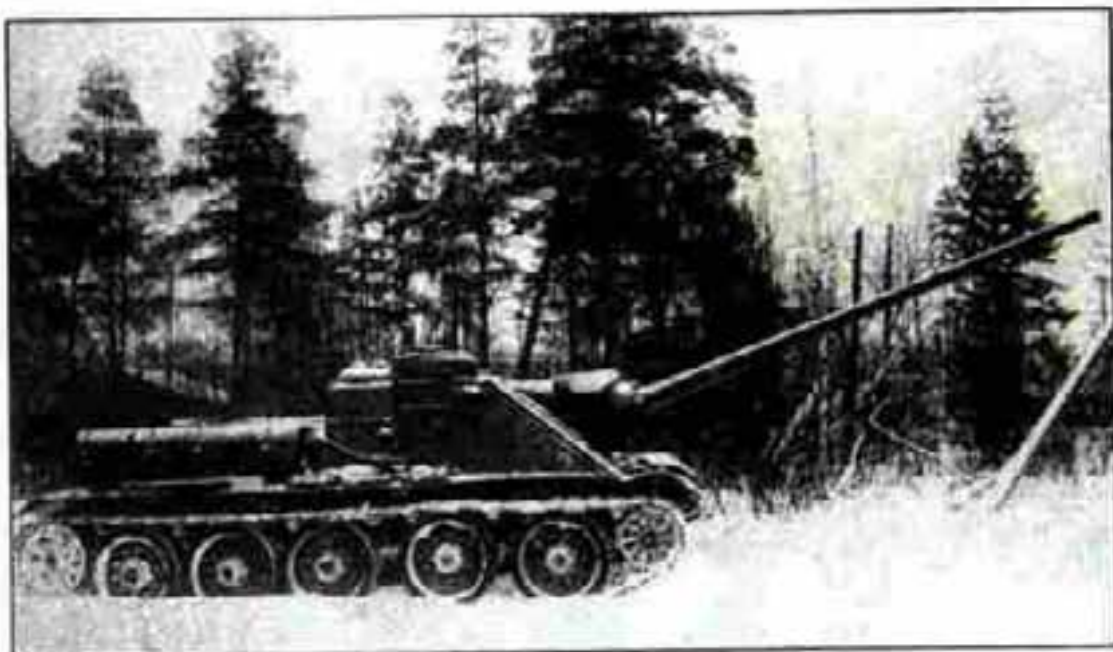
СУ-100, вооруженная 85-мм орудием большой мощности Д-10-85, 1945 г.
