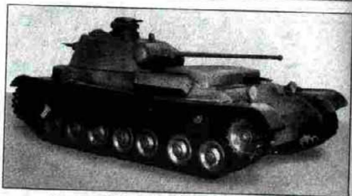
Макет танка А-44 с вооружением из 57-мм пушки. 1941 г.
