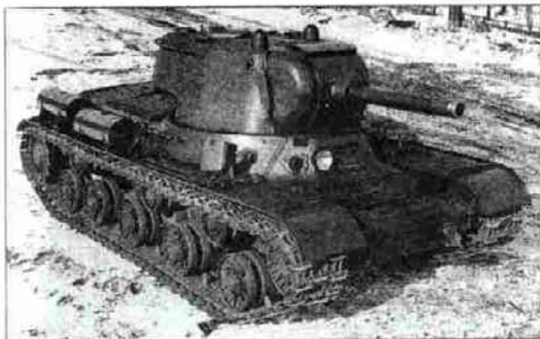
Танк ИС-2 («Объект 234») на испытаниях. Весна 1943 г.
