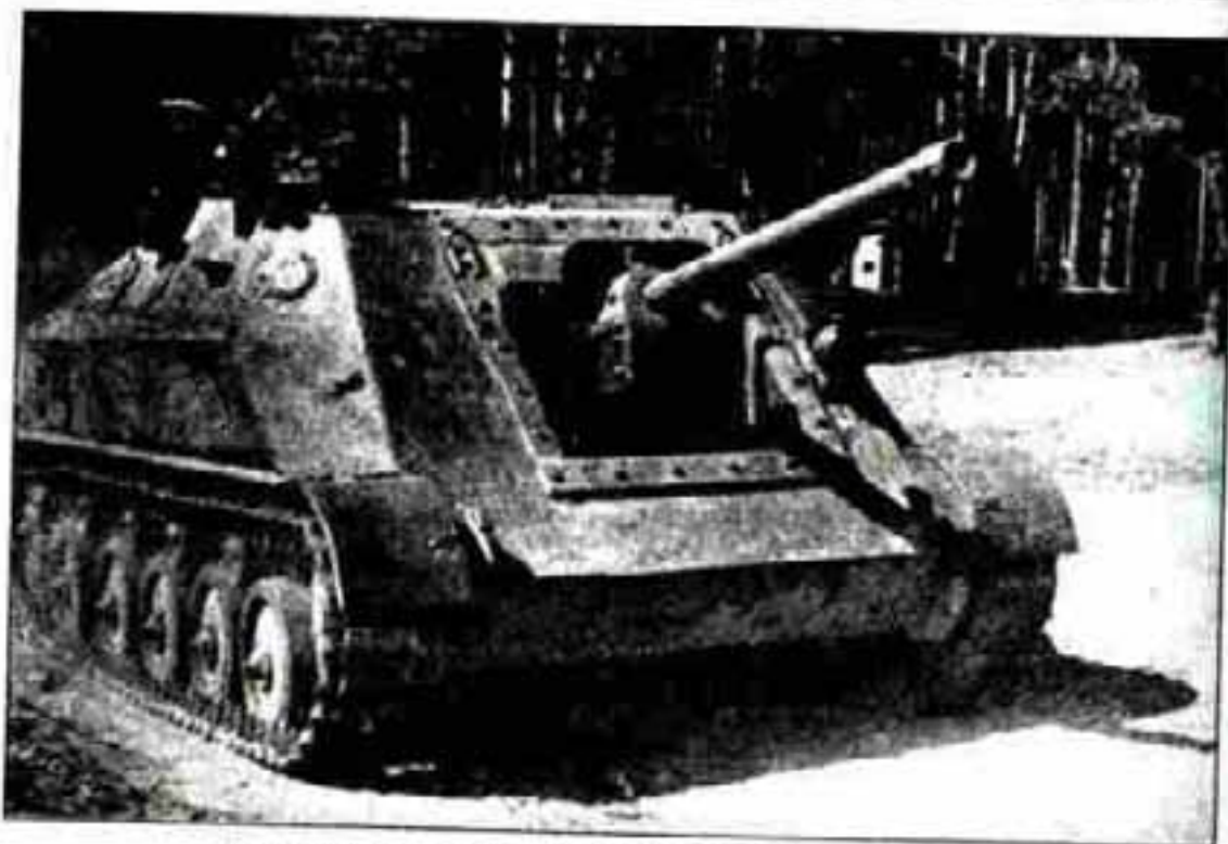
Легкий истребитель танков СУ-76Д (СУ-80). 1943 г.
