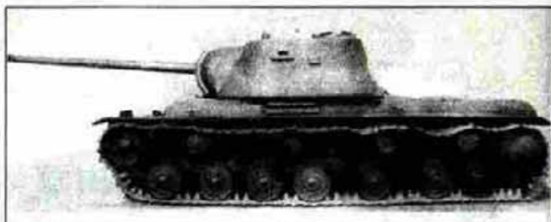
Модель танка КВ-3 с вооружением из 106,7-мм пушки, 1941 г.
