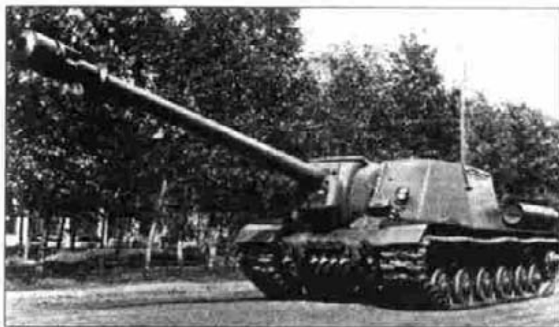
ИСУ-152-2, вооруженная 152-мм орудием БЛ-10. 1945 г.
