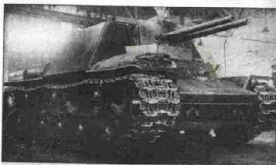
Второй вариант танка КВ-7 со спаренной оружейной установкой У-14. 1942 г.
