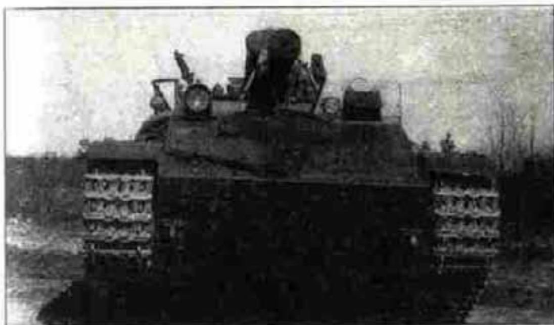
203,2-мм самоходная гаубица СУ-14-1 спереди. 1936 г.
