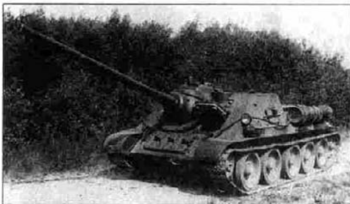
СУ-85, вооруженная 85-мм орудием большой мощности С-34-1В, слева.
