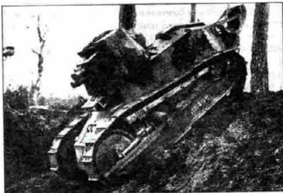
Французское 75-мм орудие поддержки на шасси танка «Рено», 1918–1920 гг.
