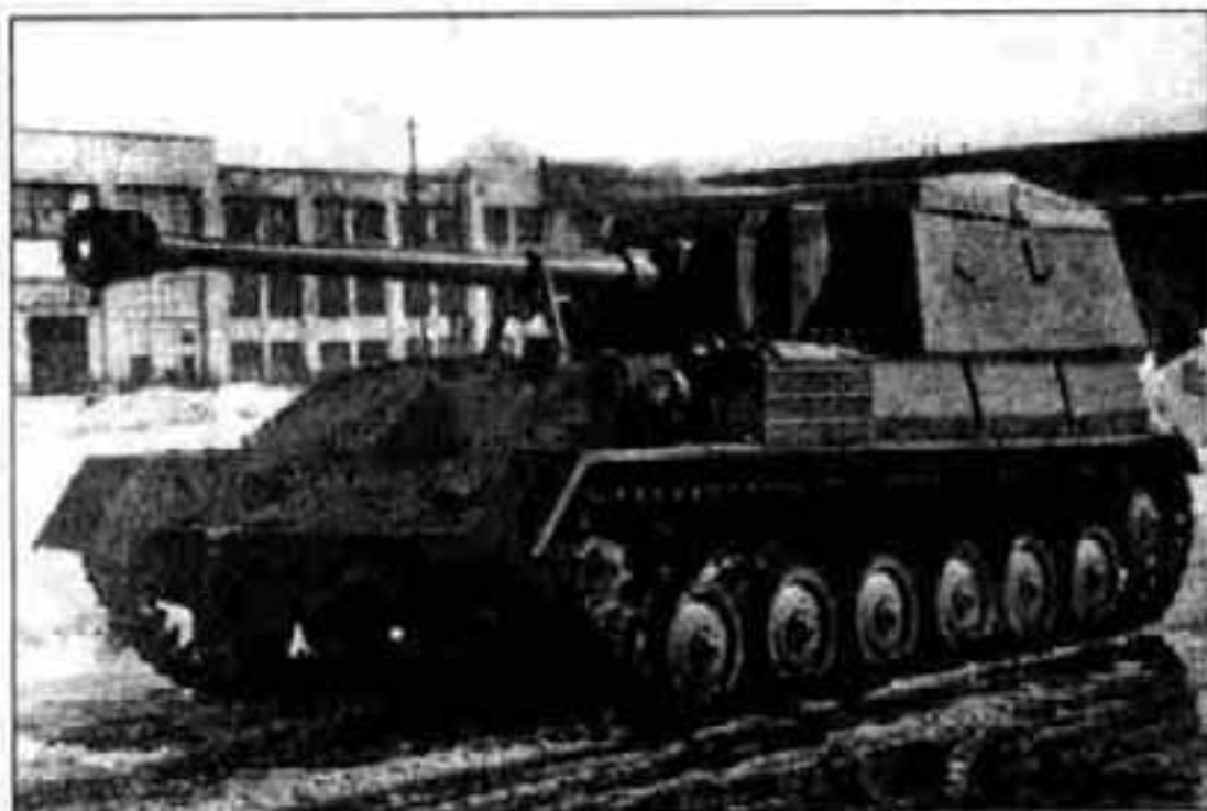
Опытный образец легкой САУ СУ-85Б, вооруженной орудием ЛБ-2. Весна 1945 гт.
