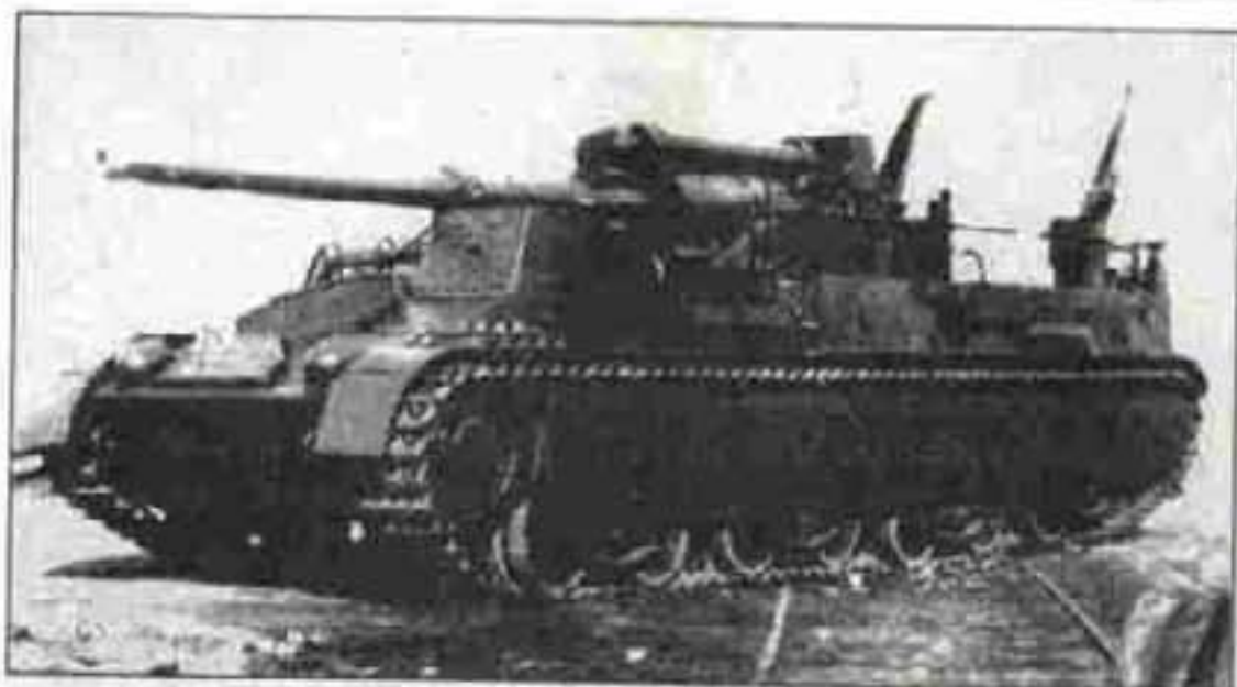
152,4-мм самоходная пушка СУ-14, перевооруженная орудием У-10. 1937 г.
