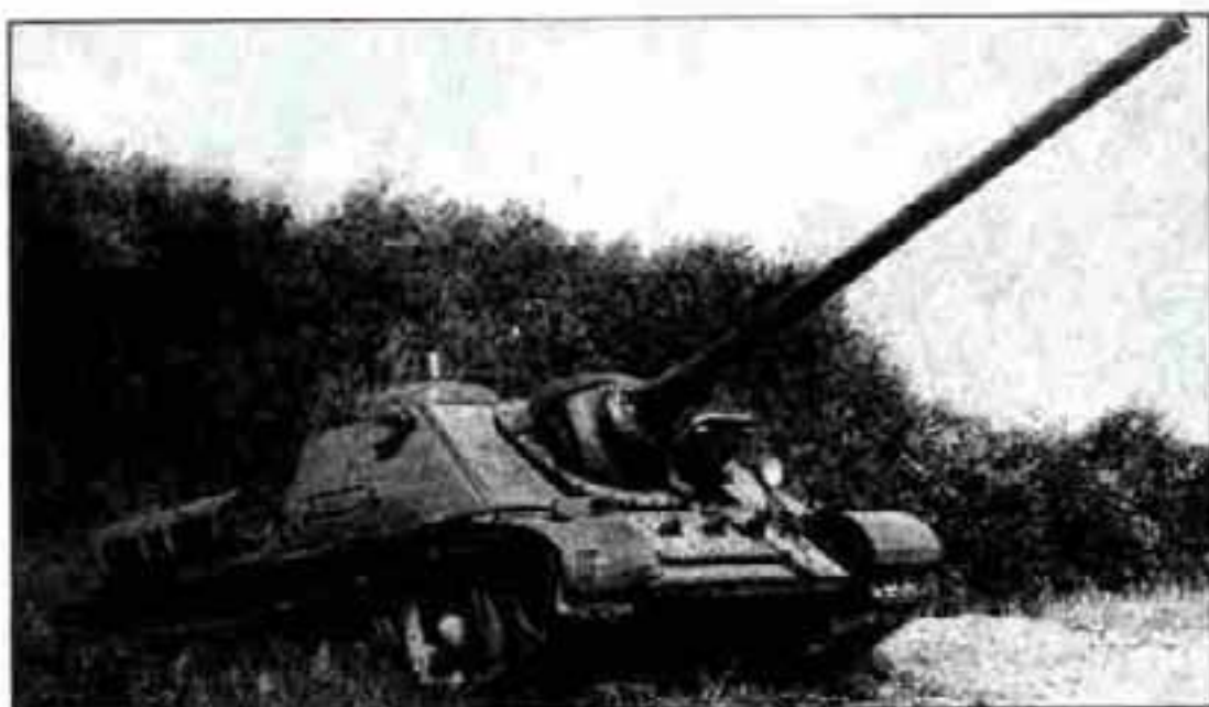
СУ-85, вооруженная 85-мм орудием большой мощности С-34-ІВ. 1944 г.
