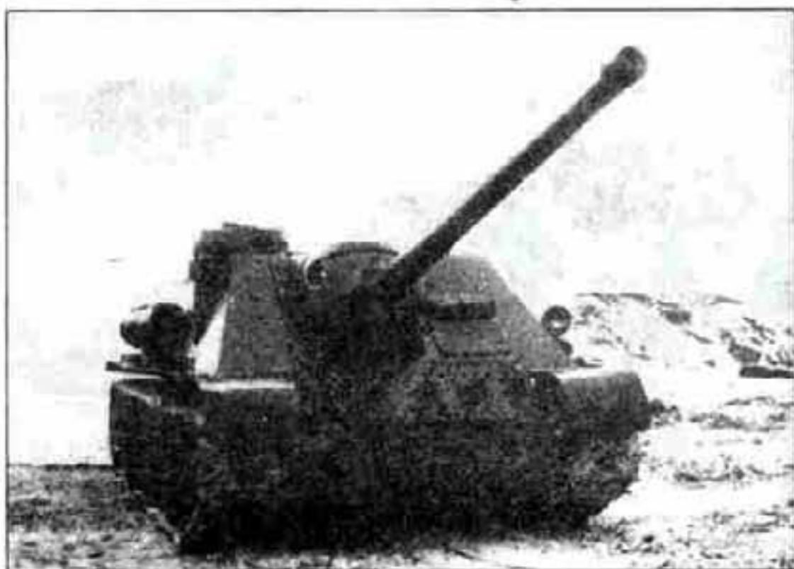
Первый опытный образец СУ-100 с пушкой Д-10С. Февраль 1944 г.
