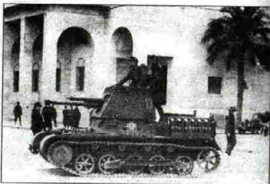
Легкий 47-мм истребитель танков Panzerjäger I. 1941 г.
