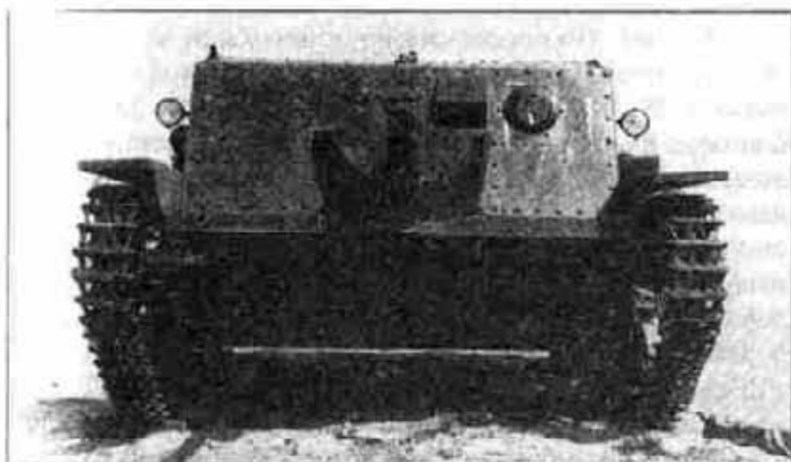
Вид спереди CV-45 на шасси танка Т-38. 1936 г.
